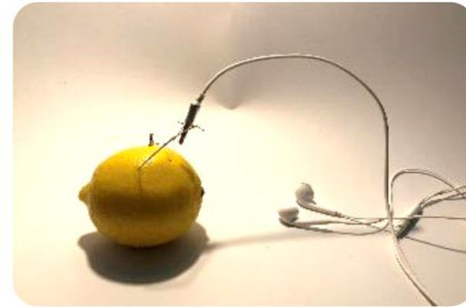
**Rendere la corrente udibile.** Ora posizionare il connettore delle cuffie tra il cavo e la graffetta. Il flusso di corrente non è visibile, ma si può udire. Inserire le cuffie nelle orecchie e ascoltare attentamente: gracchiano? Ci sono altri frutti in grado di condurre elettricità? Fai una prova!
